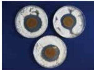
【試験法】 「JIS Z2911(2000)8.塗料の試験」を参考に試験を行った。
