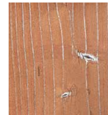
MOKリバブラスト処理 ひび割れも無くほとんど劣化は見られない。 テープで剥離しても着色層はほぼ剥 がれない。
