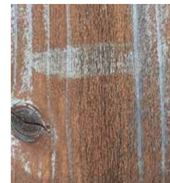
研磨処理 木材の劣化により表面が細かくひび割れ ておりテープで剥離すると着色層が剥 がれてしまった。
